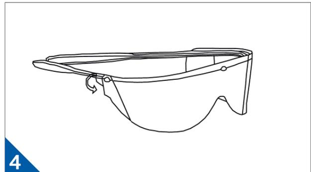
4 Retire la película exterior utilizando el mismo método que en el paso 2, y luego acople el seguro.
